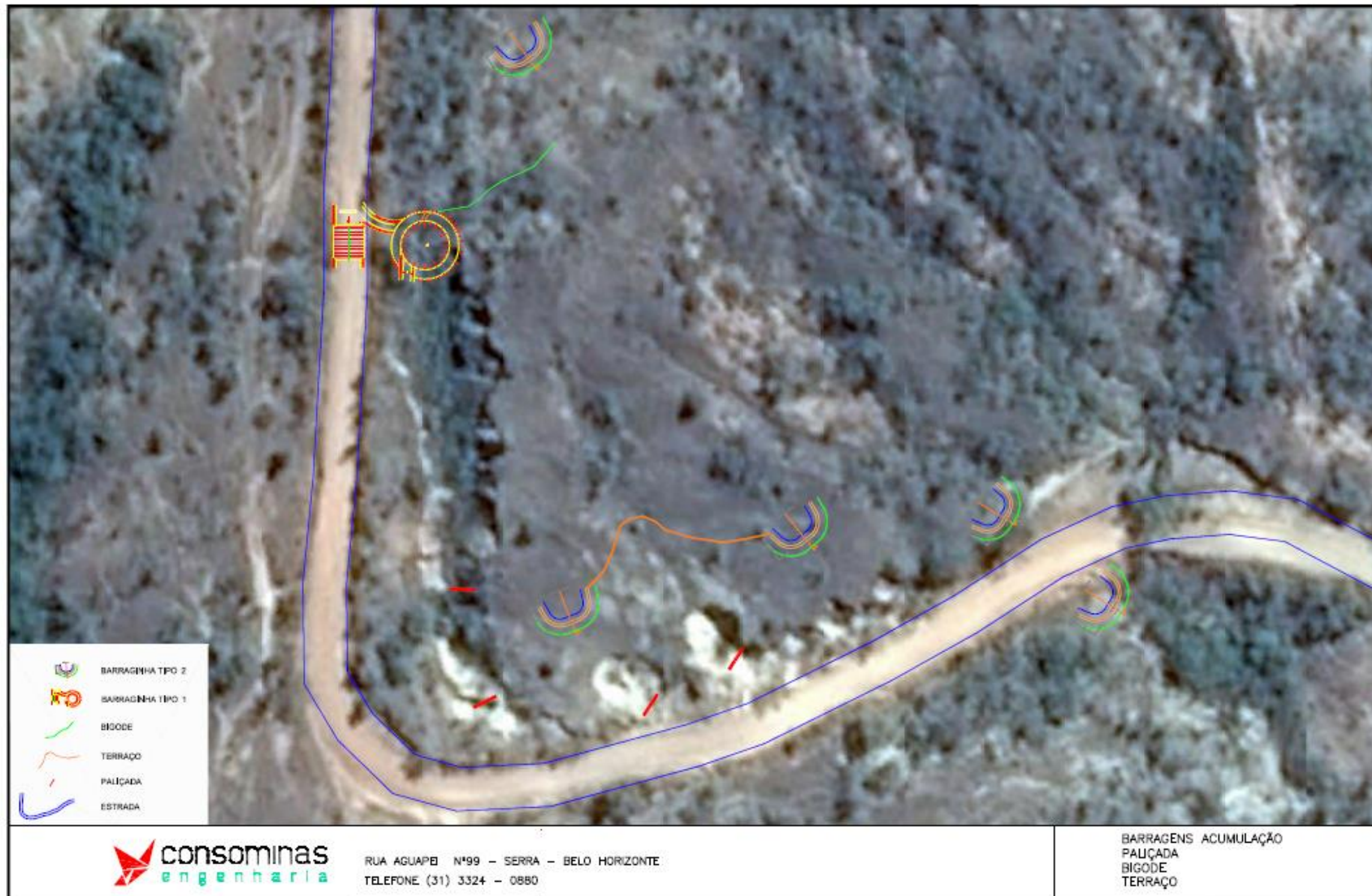
Figura 32: Intervenções para disciplinamento e contenção das águas de enxurrada causadoras da erosão
