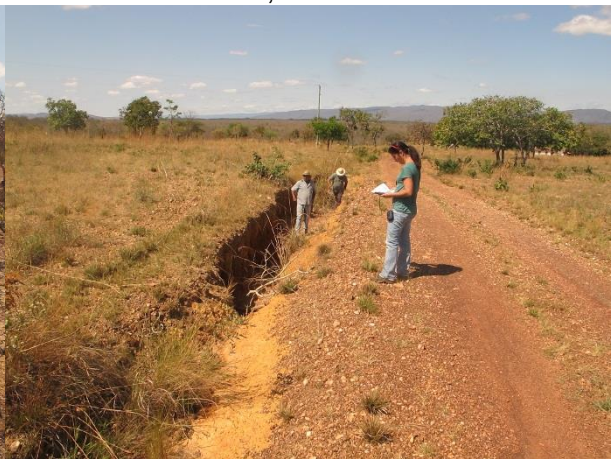
Foto 4: Local indicado para execução de paliçada em erosão em sulco. (Coord. UTM 587433 / 8003888)
